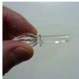
ペン先のガラス軸径φ4mmに、シリコン製チューブが被せてあります。
